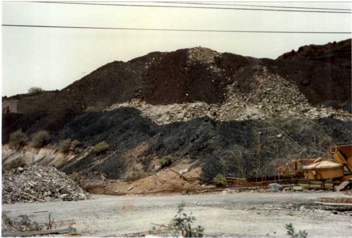
Fotg 5 : Vertido de escombros procedentes de la construcción, sobre residuos procedentes de una explotación abandonada de "Picón" en Gran Canarias.
